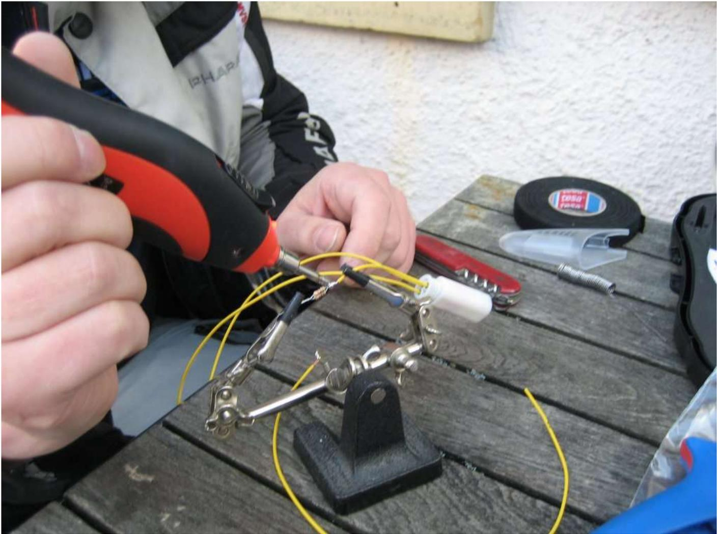
das abgeschnittene Massekabel wird dann auch wieder an gelötet und äquivalent mit dem Plus-Kabel verfahren... Das ganze sieht dann schaltungstechnisch so aus:
