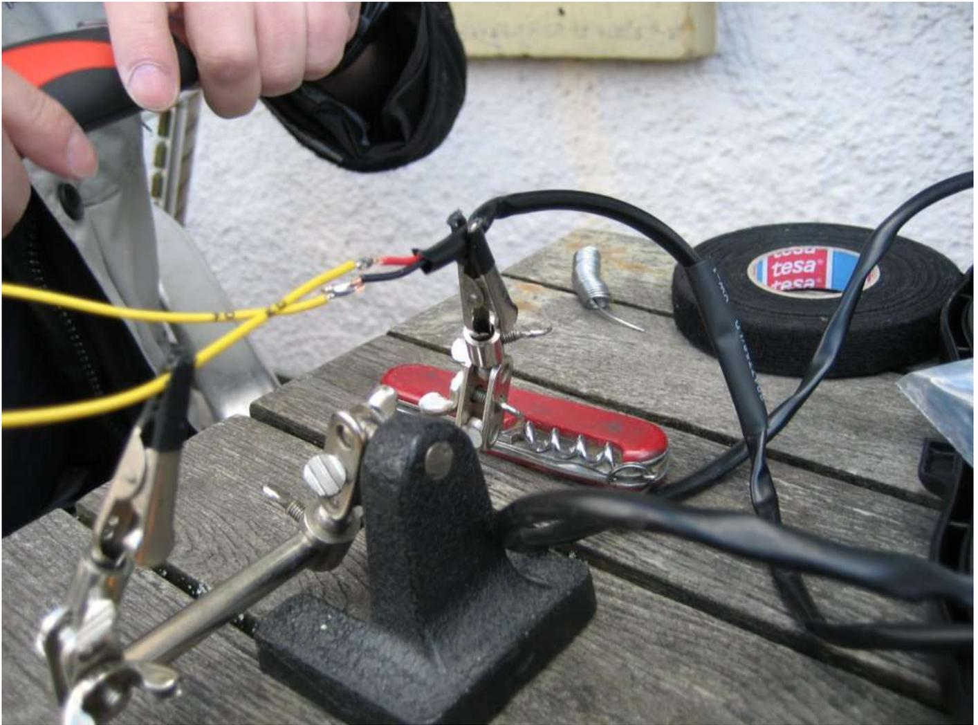
Vor dem Löten kommen natürlich zwei dünne Schrumpfschläuche über die Adern und ein dicken über das Kabel. Geschrumpft sieht das fertige Kabel dann so aus:
